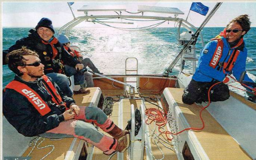
Pratique Le cockpit recouvert de liège projeté est grand et fonctionnel. Le surbau, dans le fond, permet d'être bien calé à la gîte. A noter le portique avec arceau amovible qui supporte deux panneaux solaires de 100 watts chacun.
