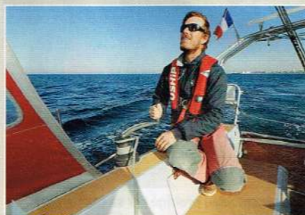
Pas pratique Les winches d'embrague sont un peu petits pour la taille des voiles d'avant.
