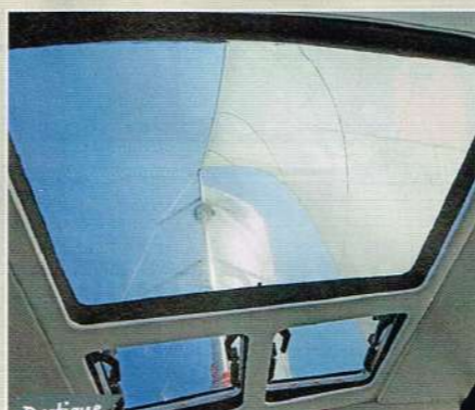
Pratique Les grands panneaux de pont zénithaux permettent de garder un œil sur les voiles depuis les bannettes du carré.
