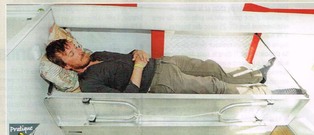
Pratique Les bannettes du carré sont pourvues de véritables cloisons anti-roulis. Celles-ci, en position basse, permettent également d'agrandir la couchette lors des escales au port.
