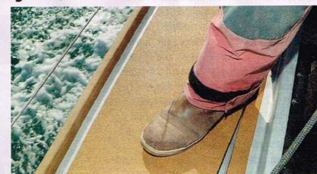
▲ L'antidérapant en liège projeté remplit parfaitement son office même lorsque le pont est trempé par les embruns.
